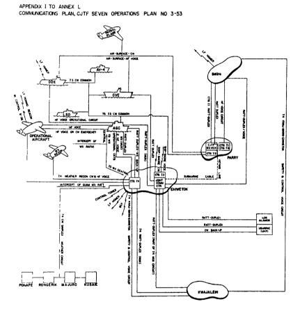
PRINCIPLE TASK FORCE HF RADIO CIRCUITS
