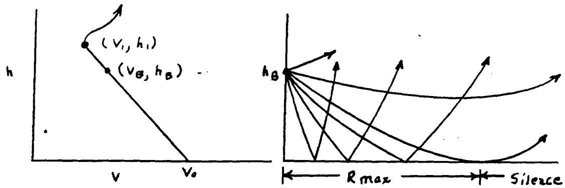
$$R_{max} = h_B \left( \frac{v_0 + v_B}{v_0 - v_B} \right)^{\frac{1}{2}} \quad 1)$$
